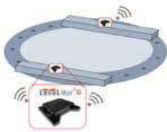
排水口/法蘭傾斜檢測
